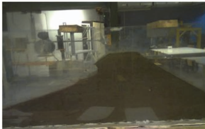
Figure 6. Configuration 1 – rupture de la pente aval pour une charge hydraulique de 34,5 cm
